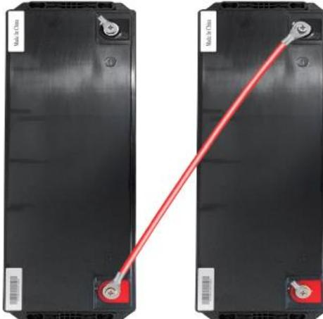
Sarjaan kytkettävien akkujen tulee olla samassa jännitteessä ennen niiden liittämistä ja suurin sallittu jännite-ero akkujen välillä on 0,1 V. Parhaan tuloksen saavuttamiseksi lataa jokainen yksittäinen 25,6 V:n akku täyteen laturilla **ennen niiden kytkemistä sarjaan** varmistaaksesi, että ne ovat samassa varaustilassa.
